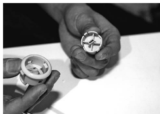
②上蓋を外したところ ボタンは大別して凹型の受け皿と凸型のプッシュ部分、そしてスイッチ（主にキースイッチ）で構成されている
