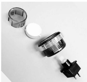
画像はセイムツ工業製のPS-14-KNをバラしたものだ。 右下のキースイッチが入力感のキモとなる
