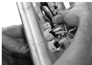
②ファストン端子を抜く 端子をしっかりと掴んで抜く。断線の恐れがあるのでコードを引っ張ってはいけない。コードの色は覚えておくこと
