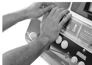
④新しいボタンを付ける 手のひら全体でギュッと押し込む。コードは色を間違えないように繋ぐこと。わからなくなったら2P側、または他の筐体を参考にしよう
